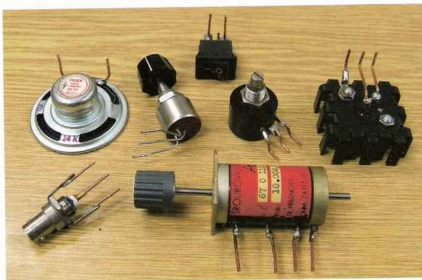
Obr. 8. Ukázka některých součástek připravených k montáži do svorkovnic, potenciometry TP 195 již vhodné vývody mají
