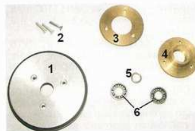
Obr. 9. Kolo robota Century, 1 - pojezdové kolo i s pneumatikou; 2 - šrouby M2, které drží celek kola pohromadě; 3 - ozubené kolo, 4 - unašeč, 5 - mezikružní, 6 - ložiska
