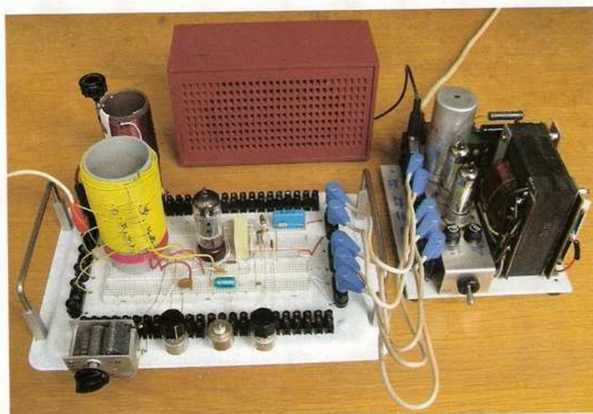
Obr. 11. Ověřování funkce reflexního jednoelektronkového přijímače na ED
