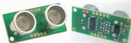
Obr. 3. Kompaktní modul ultrazvukového snímače vzdálenosti SRF05
